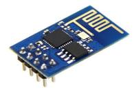
Fig. 2. ESP8266 Wi-Fi module [13-14].
