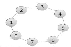
Fig. 1.4(b). Ring Network-Token ring algorithm.
