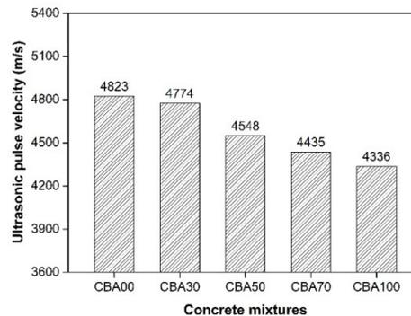
Fig. 4. UPV values of concretes.
